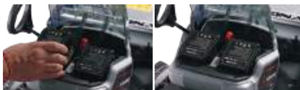
Due batterie da 5Ah e chiave di sicurezza
